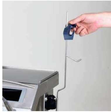
Ablage für Motor einhängen und fixieren.
