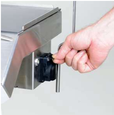
Pumpendeckel öffnen. Griff nach oben ziehen.
